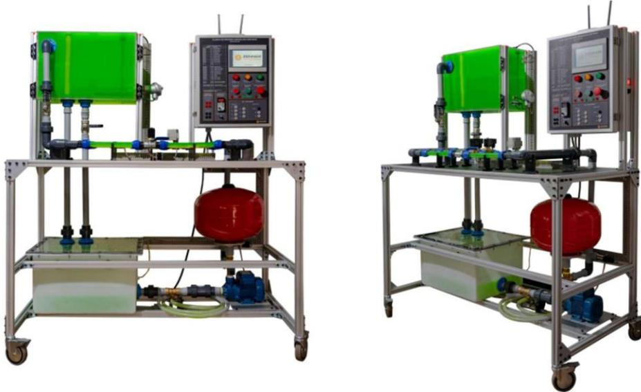
Planta de un proceso hidráulico continuo orientado al aprendizaje integral para especialidades industriales. El estudiante será capaz de conocer componentes con estándares y calidad industrial, identificarlos en planos, y con ellos realizar tareas de programación y mantención de la planta para su correcto funcionamiento.
